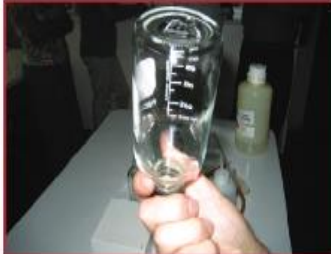
Pemolesan insektisida ( coating ) pada bagian atas botol
